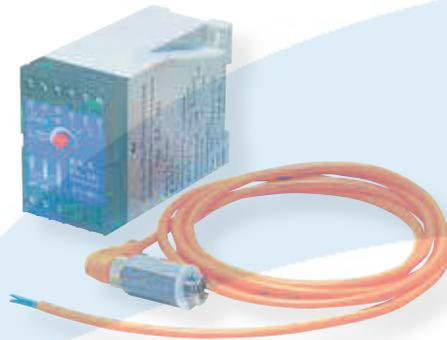
En caso de que se produzca un fallo del diafragma, el producto bombeado penetra en la cámara de aire y activa el sensor. El sensor envía entonces una señal eléctrica al dispositivo de control para su evaluación. La unidad de control conmuta el suministro de aire a la válvula de aire y así detiene el funcionamiento de la bomba.
