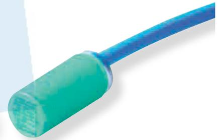
El sensor contador de impulsos cuenta cada ciclo de movimiento del diafragma. Multiplicando el número de ciclos por los volúmenes de la cámara de bombeo se puede determinar el caudal. Para aplicaciones de dosificación, el contador de impulsos proporciona una medición precisa y una regulación exacta.
